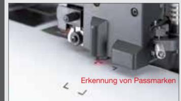
Bis zu vier Passmarken werden erkannt. Im Nutzen gedruckte Bilder können so automatisch in X- und Y-Richtung beschnitten werden. Mit Mimakis FineCut Software muss sogar nur ein Punkt eingelesen werden.
