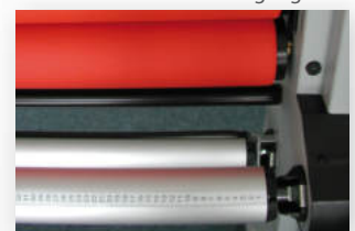
Leichtspann-Mandrells und einfacher Walzen-Zugang
