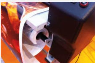
Schneller Folienrollenwechsel durch leicht zu entnehmende Mandrell
